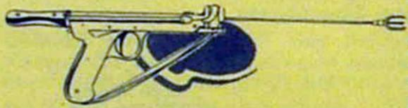
ist eine sehr handliche Gummizugharpunen-Pistole, die zur Jagd auf kleine Fische hervorragend geeignet ist. Alle Teile am Harpunengewehr sind seewasserbeständig, der Gummizug ist auswechselbar; der Abzug besitzt eine Sicherungsvorrichtung. Die Dreizackspitze des Pfeiles ist ebenfalls auswechselbar.
