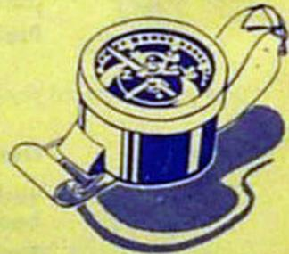
**BARAKUDA-TIEFENANZEIGER** zeigt die Wassertiefe mit Hilfe einer Boyle-Mariott'schen Röhre an (Ablesung ähnlich wie bei einer Thermometer-Skala). Das Volumen der Meßkanüle ist mit Hilfe eines Stöpsels regulierbar. Bei eingedrungenem Wasser Stöpsel herausziehen und Kanüle durchblasen.
