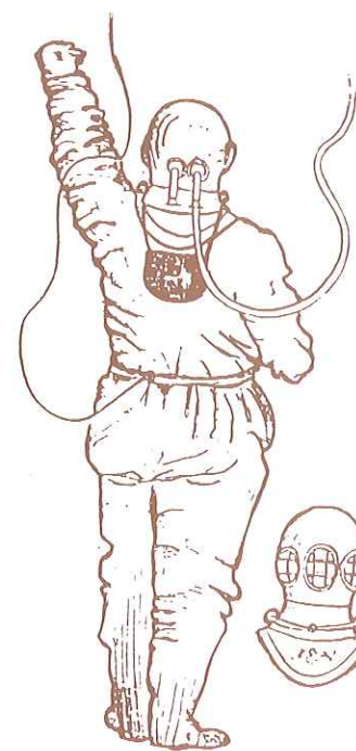
Fig. 11 - Illustrazione dello scafandro Deane che mostra un breve tubo di scarico dietro l'elmo - 1842
