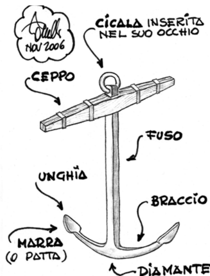
Schema dei componenti l'ancora ammiragliata con ceppo fisso in legno (dis. F. Rambelli).
