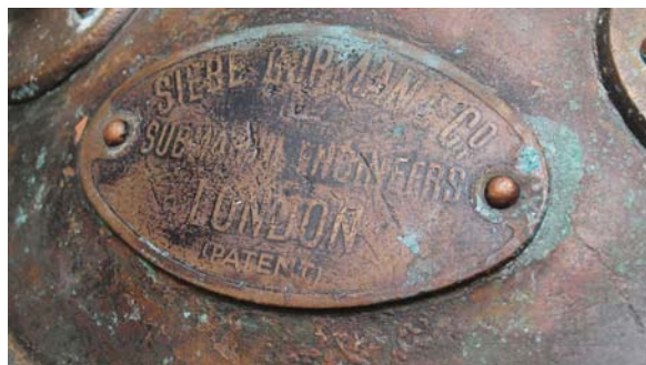
Figura 12 – Targhetta adottata dagli anni Venti in avanti. Stampata con lettere in rilievo e smaltata. La caratteristica di questa targhetta era la facile usura che, con il passare degli anni, rendeva pressoché illeggibili le scritte.
