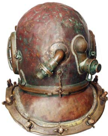
Figura 5 – Vista posteriore dell'elmo in figura 4. La valvola di scarico si sta spostando verso il lato. I modelli successivi proporranno un ulteriore spostamento finale in posizione ancora più laterale.
