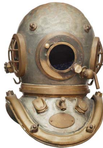
Figura 16 – Elmo Siebe Gorman & Co. Ltd sei bulloni. Sul collare trova posto un attacco per bomboline di aria compressa alloggiata nella zavorra pettorale. Modello chiamato anche Royal Dutch Engineers perché fabbricato su specifiche del corpo della Marina olandese. Periodo anni '50. Anche in questo caso si tratta di un modello abbastanza raro da reperire.
