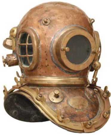
Figura 13 – Elmo Siebe, Gorman & Co Ltd dodici bulloni databile intorno agli anni '30. I galletti non sono gli originali forniti dalla ditta ma una serie di probabile recupero da parte del palombaro.
