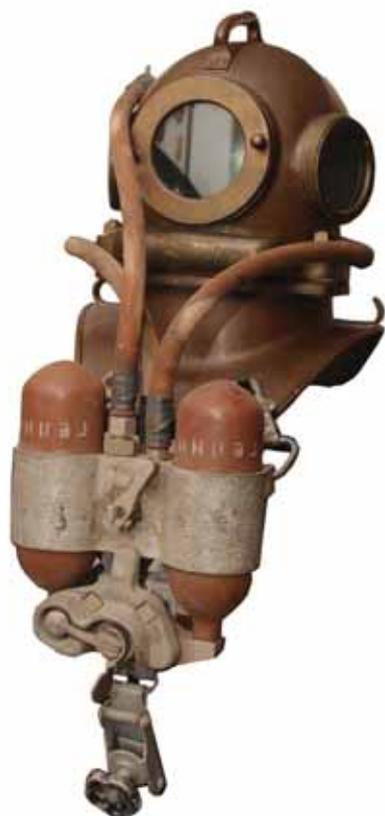
Elmo GKS -3M per uso di miscela elio/ossigeno fino a 200 metri di profondità. Questo modello fu il successore del GKS-3 e venne introdotto intorno al 1962. L'unica differenza con il suo predecessore risiedeva in un "sistema venturi" più performante: riusciva a fare 10 cicli al minuto contro i 6 del vecchio elmo. Sul davanti le bombole di "bailout" che fungevano anche da zavorra pettorale.
