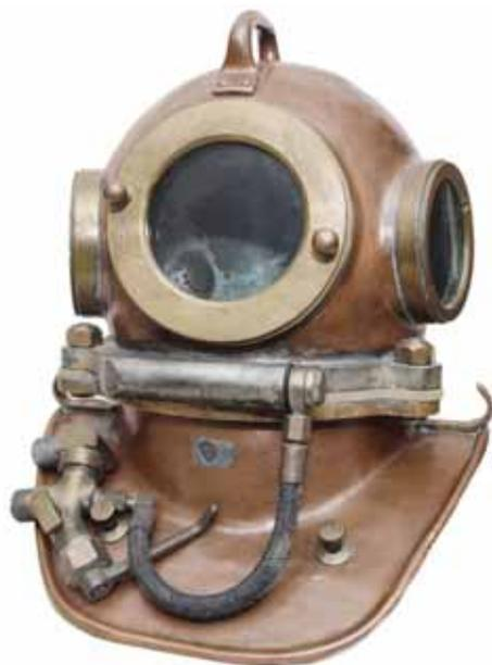
Elmo WKS-57 modificato. Questo elmo risulta essere un ibrido costituito dalla testa di un elmo GKS-3 alla quale è stato saldato l'anello dell'iniettore. Il funzionamento è esattamente identico a quello del WKS-57 ma, modificato in questo modo, risulta sicuramente più snello.
