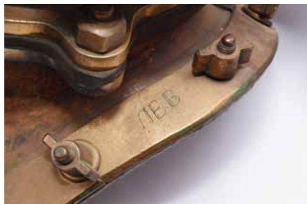
incisioni artigianali fatte sui settori del collare dell'elmo 3/12 bulloni. Indicano il posizionamento sul collare (avanti, dietro, destra, sinistra). Un modo rudimentale per evitare ogni volta di cercare la posizione idonea per i quattro settori.
