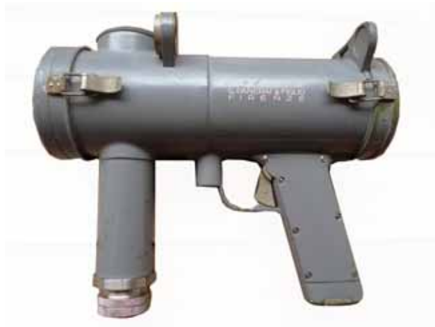
FOTO 14 – Elettrosegnalatore a pile impiegato sulle navi per le segnalazioni luminose.
