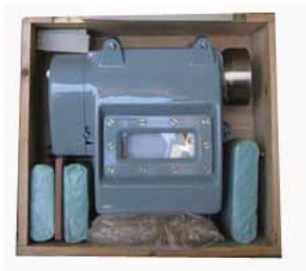
FOTO 15 – Profondimetro con registratore del tracciato del fondale, anni 60/70. Indossato sulla schiena da un subacqueo che procede strisciando sul fondale, rileva la profondità e traccia un grafico dell'andamento del fondale. Nelle intenzioni doveva essere usato per rilevare il fondale prospiciente la battigia in preparazione dello sbarco di truppe.
