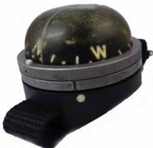
FOTO 10 - Bussola Luminor Panerai anni Sessanta. Questa bussola adotta un quadrante tronco conico che va così a risolvere il problema della lettura a bussola inclinata (Il quadrante piatto tendeva a incepparsi nel movimento rotatorio). Ne fu fatto un modello con una mascheratura che lasciava aperta solo una fessura per la lettura del quadrante, un accorgimento per limitare la forte luminescenza che poteva essere notata, di notte, anche fuori dall'acqua
