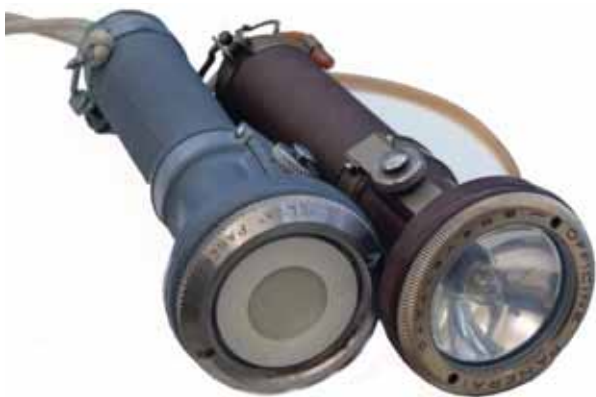
FOTO 13 – Torce subacquee Panerai a compensazione manometrica, anni 50/60. Corpo metallico rivestito in gomma antisalmastro e antiolio con pulsante per lampi di luce e sistema di bloccaggio del pulsante per fissarlo in posizione spento o acceso. La torcia di destra ha una lampadina classica mentre quella di sinistra utilizza un brevetto Panerai di nome Elux. In questa torcia è sostituita da un disco elettroluminescente in grado di emettere una luce biancastra.
