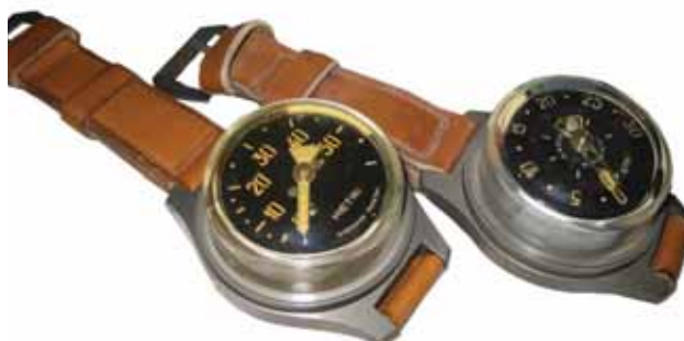
FOTO 11 - Profondimetri da “difesa” Radiomir Panerai. I profondimetri sono del tipo a meccanismo Bourdon, con scale variabili a seconda della profondità massima. Quello cosiddetto “da attacco” porta la scala fino a -16 metri, non essendo previsto nelle fasi di attacco a basi nemiche la possibilità di raggiungere particolari profondità. Quelli da “difesa” svolgono, invece, la funzione di un vero e proprio profondimetro necessario per le normali immersioni di recupero o sminamento. Vennero fatti anche nel tipo Luminor dalla fine degli anni 40, con possibilità di tarare il quadrante rispetto allo zero misurato dalla lancetta in superficie.
