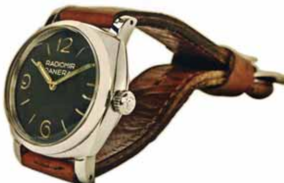
FOTO 4 – Orologio Radiomir Panerai modello 3646 con le anse di pezzo ricavate nel blocco cassa. Questa modifica rese gli attacchi del cinturino molto più solidi. Movimento Rolex. Ha un quadrante dove venivano "traforate" le cifre e gli indici. Al di sotto veniva posizionata un'altra piastra ricoperta di materiale fosforescente Radiomir. Grazie a questo quadrante a sandwich, si era in grado di rendere molto luminosi gli indicatori. (da opera già citata)
