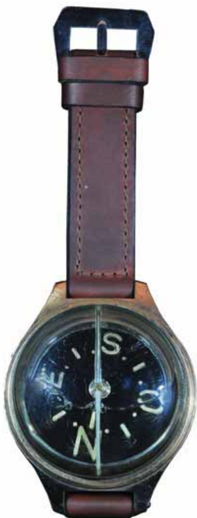
FOTO 8 - Bussola Panerai. La bussola era lo strumento fondamentale per impostare nel buio della notte la giusta rotta verso l'obiettivo da attaccare. Questa bussola, con quadrante di tipo Radiomir, ha una base in metallo amagnetico su cui è fissata la rosa costituita da un quadrante circolare piatto. Il quadrante è racchiuso in una cupola in perspex e galleggia in un liquido trasparente.
