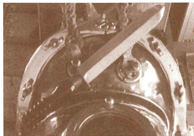
Pugnale Siebe-Gorman anti-magnetico fuori dalla sua guaina. La lama potrebbe essere al titanio, il manico in bachelite è attraversato da una sbarra d'acciaio. Per la loro eleganza e fattura si dice che la Siebe-Gorman nel progettarli si sia ispirata agli antichi gladii romani. (Collezione Bertora)
